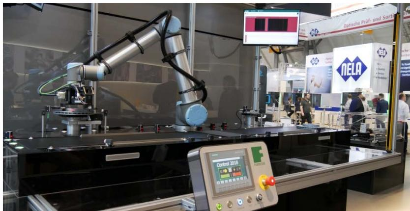
*Abbildung 4: Automatisiertes Bremscheiben-Prüfsystem mit der STATOVISION Software*
