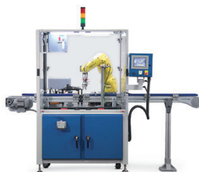
Abb. 2: Roboterzelle zur Rissprüfung gesinterter Zahnradkomponenten
