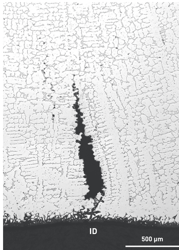
图7: 蠕变裂缝的高倍显微照片
